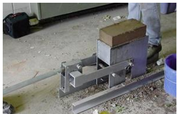
Foto N° 02: la vista muestra al bloque comprimido, listo para el proceso de curado
