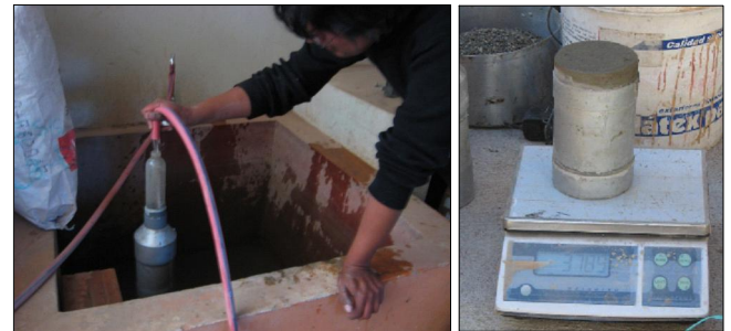
Imagen 4.1: Ensayo de medición de aire por el método volumétrico y gravimétrico.
