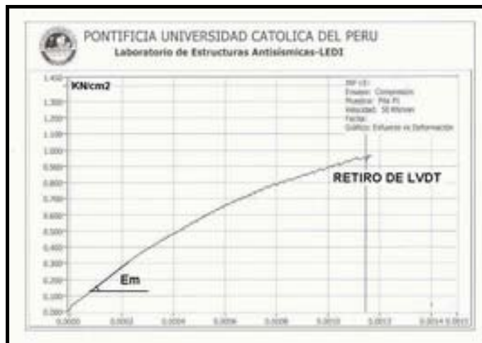
Figura 5.1 - Gráfico f_m - \epsilon para una de las pilas ensayadas.
