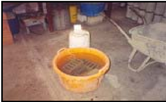
Foto 2.6 Ladrillos sumergidos en agua destilada.
