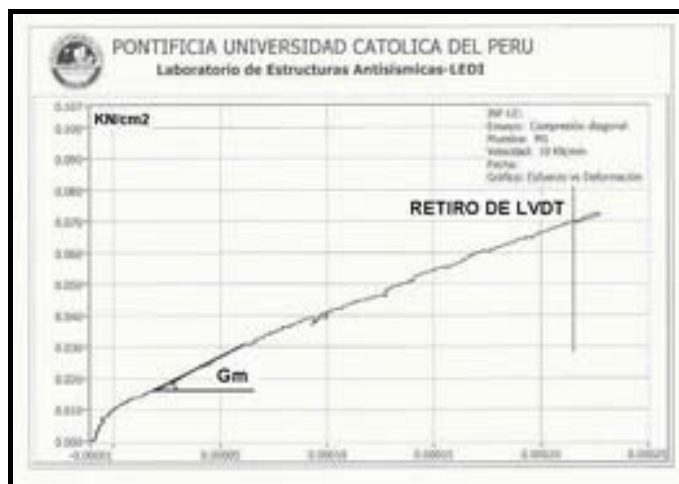
Figura 5.4 - Gráfico v_m - \gamma para uno de los muretes ensayados.
