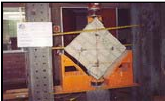
Foto 4.7 Murete instrumentado y colocado en la máquina de ensayo.
