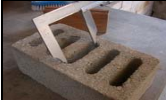
Foto 2.11 Medición de la longitud de una ranura.
