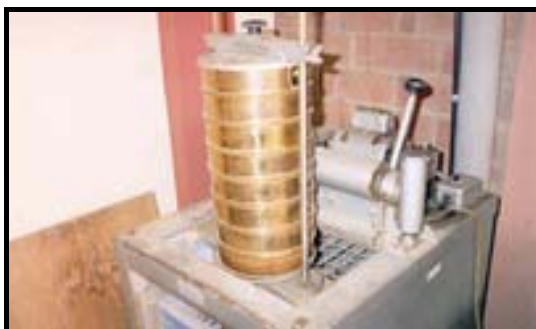
Foto 2.13 Ensayo de granulometría de la arena.
