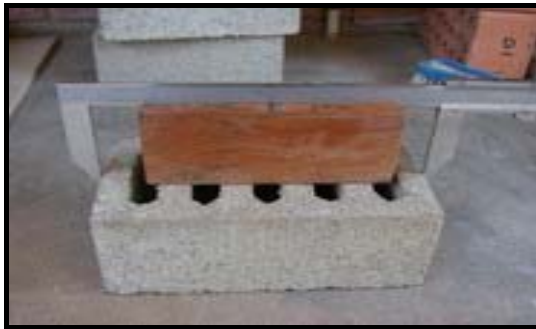
Foto 2.10 Medición de la longitud de la superficie de asiento.
